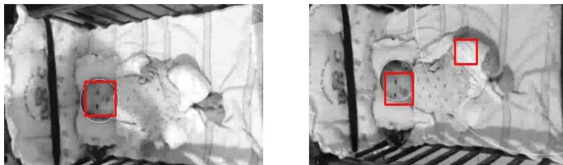
圖三、人臉(紅色方框)與圓形(白色圓框)偵測結果。(左圖)二者皆正確結果；(右圖)畫面右上方為OpenCV程式誤判結果，而運用偵測中心差距值可濾除誤判情況。
